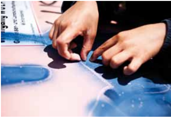
Die Farbprobe an der Streusalztonne am Bahnhof Buchholz wird mit Hilfe der Schabetechnik gewonnen. Der Abrieb bleibt am Tesa hängen
